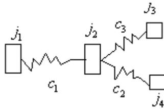
В случае безредукторного привода схема существенно упрощается.  $j_1, j_2$  - моменты инерции двигателя и канатоведущего шкива.  $j_3, j_4$  - моменты инерции поднимаемого и опускаемого скипов.
