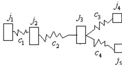
Где  $j_1$  – момент инерции двигателя и связанных с ним элементов (на одном валу)  $j_2$  – момент инерции редуктора,  $j_3$  – момент инерции барабанов,  $j_4, j_5$  – приведенные моменты инерции поднимаемого и опускаемого скипов. При наличии двух двигателей схема видоизменяется:
