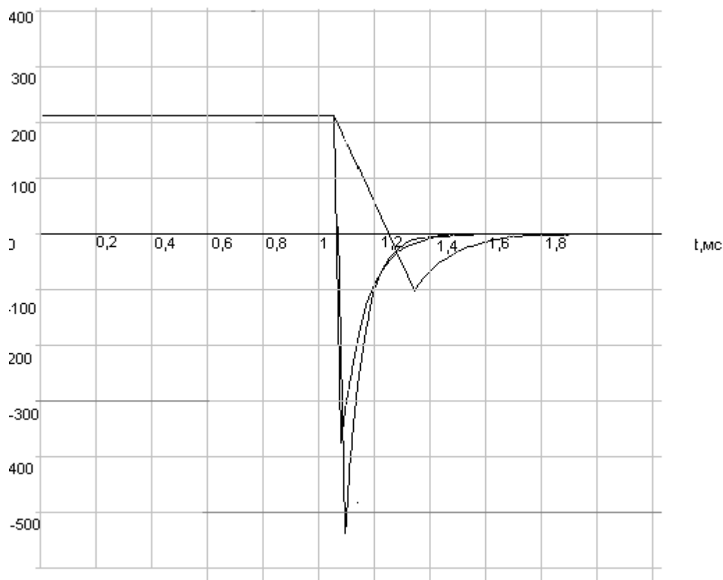
Рисунок 4 – Переходный процесс при отключении катушки, защищаемой с помощью разрядного резистора
