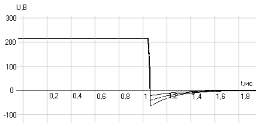
Рисунок 5 – Переходный процесс при отключении катушки, защищаемой диодом
