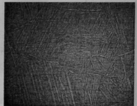
Рисунок 4 – Микроструктура металла, \times 100 : а - [O]=0,053\% , плавка № 3; б - [O]=0,083\% , плавка № 1; в - [O]=0,230\% , плавка № 6.
