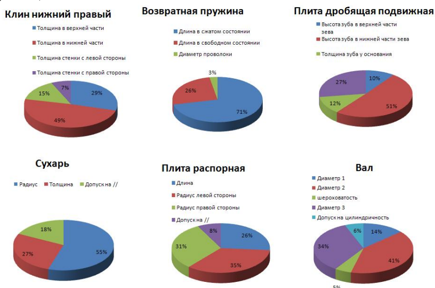
Рисунок 3 – К расчету степени влияния изменяемых параметров на уровень деградации деталей
