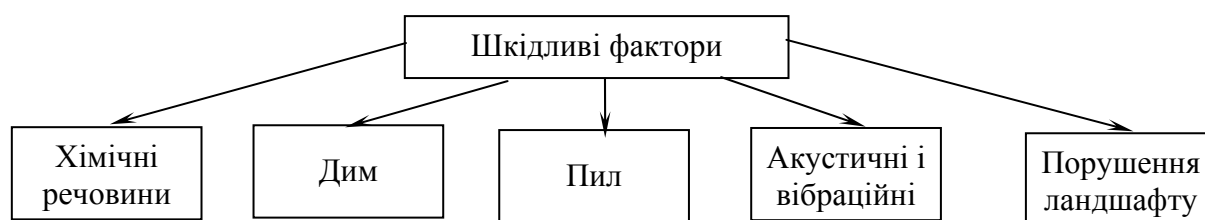
Рис. 1. Шкідливі фактори, які виникають під час реконструкції автомобільної дороги
