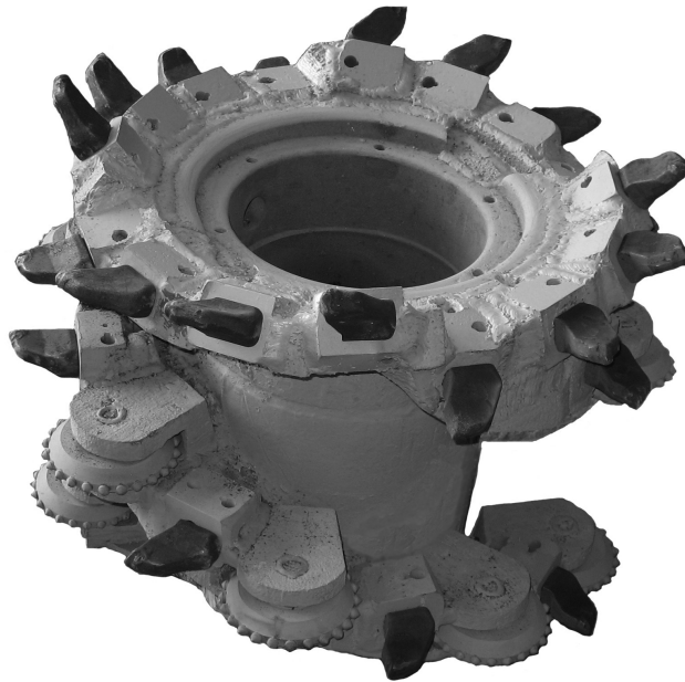
Рисунок 3 – Вид исполнительного органа с комбинированной схемой набора вращающегося режущего инструмента
