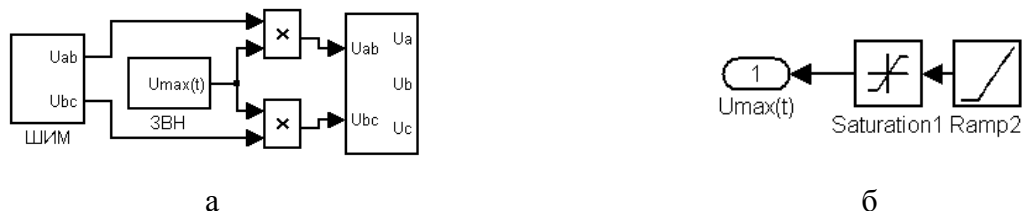
Рис. 2. Структурные модели: а – устройства мягкого пуска; б – блока задания величины напряжения ЗВН
