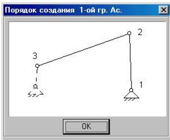
Рисунок 1.2 – Пояснення порядку приєднання групи Ассура
