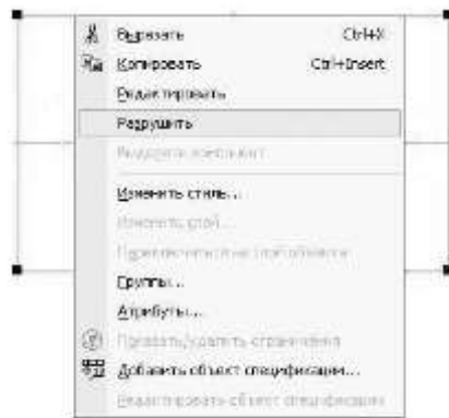
Рис.46 Разрушение контура на отрезки
