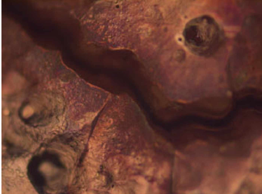
Рисунок 2. Фотографія гарячої тріщини, що утворилася унаслідок високої теплопередачі в зоні вторинного охолодження.
