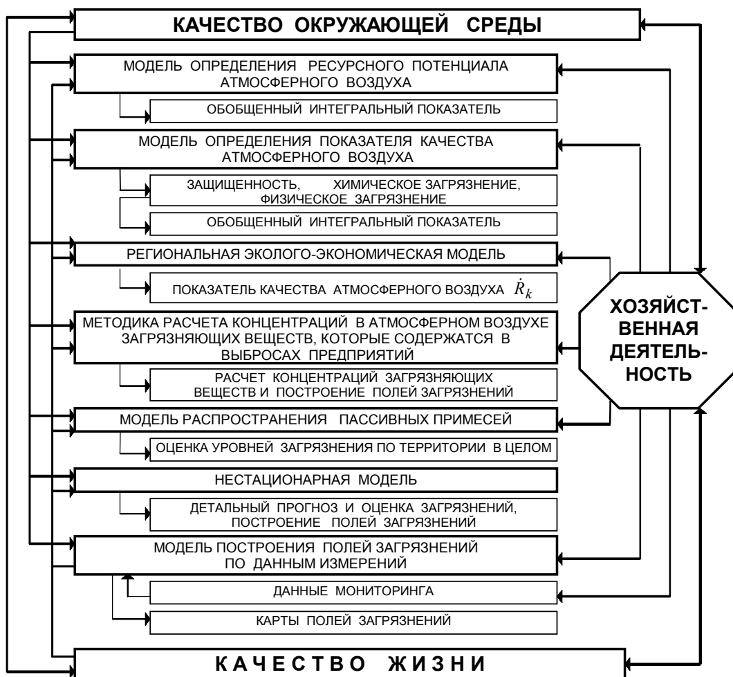
Рисунок 1 - Структурная схема программного обеспечения подсистемы прогноза и оценки загрязнения атмосферного воздуха
