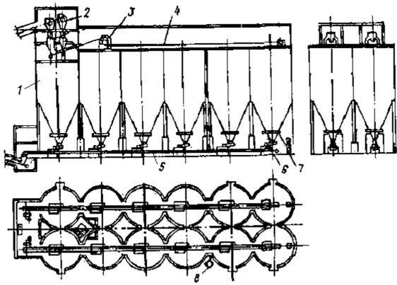
1 — бункер, 2, 4 — конвейеры; 3 — разгрузочная тележка; 5 — сборный конвейер; 6 — дозатор; 7 — устройство для пневмообрушения; 8 — ресивер сжатого воздуха
