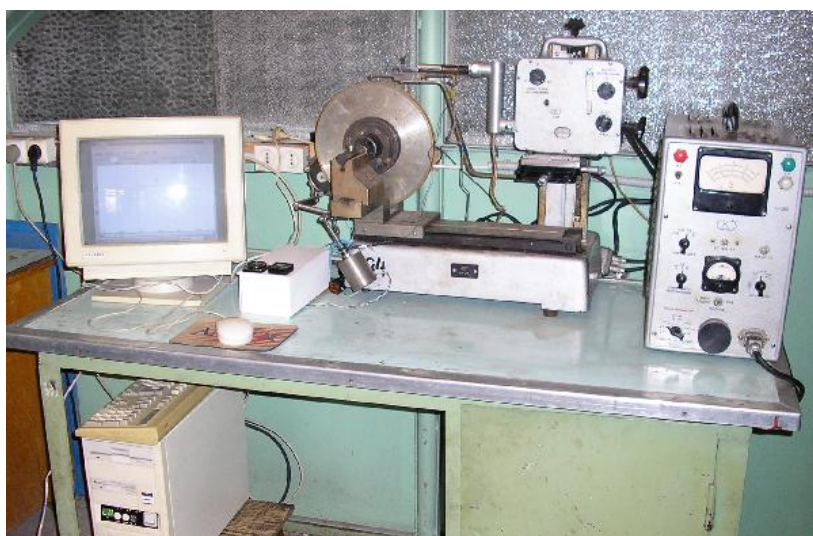
Рис. 1. Общий вид комплекса для регистрации рельефа режущей поверхности алмазных кругов на металлической связке
