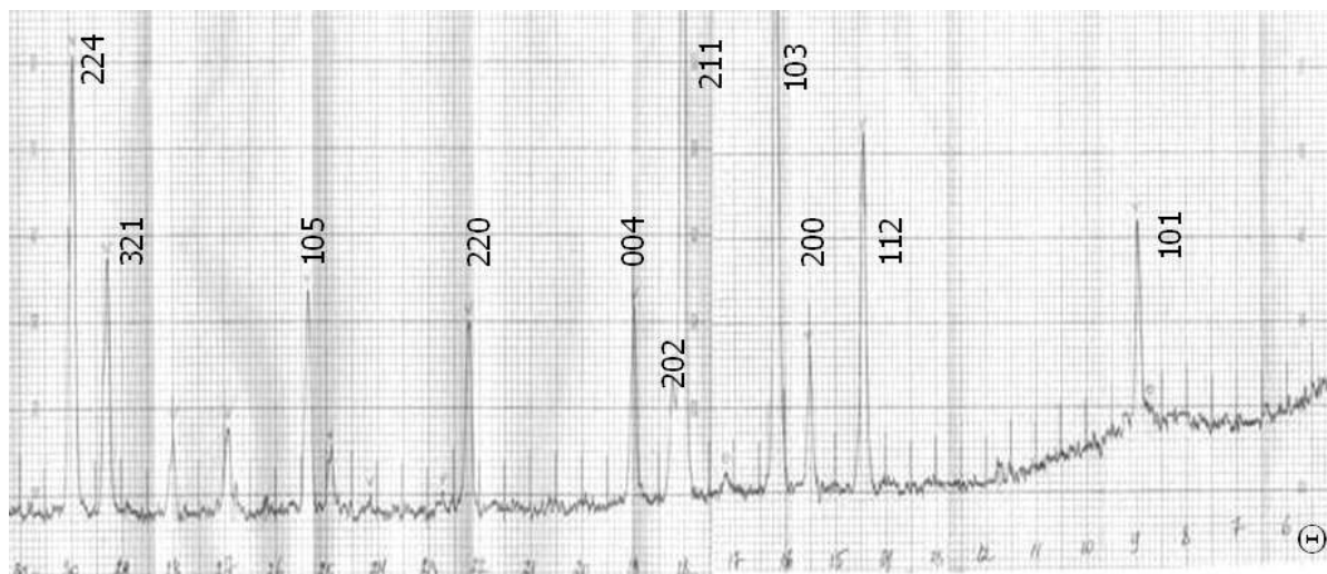
Рисунок. Дифрактограма \beta - Mn_3O_4 отриманого при t=930^\circ C на повітрі.
