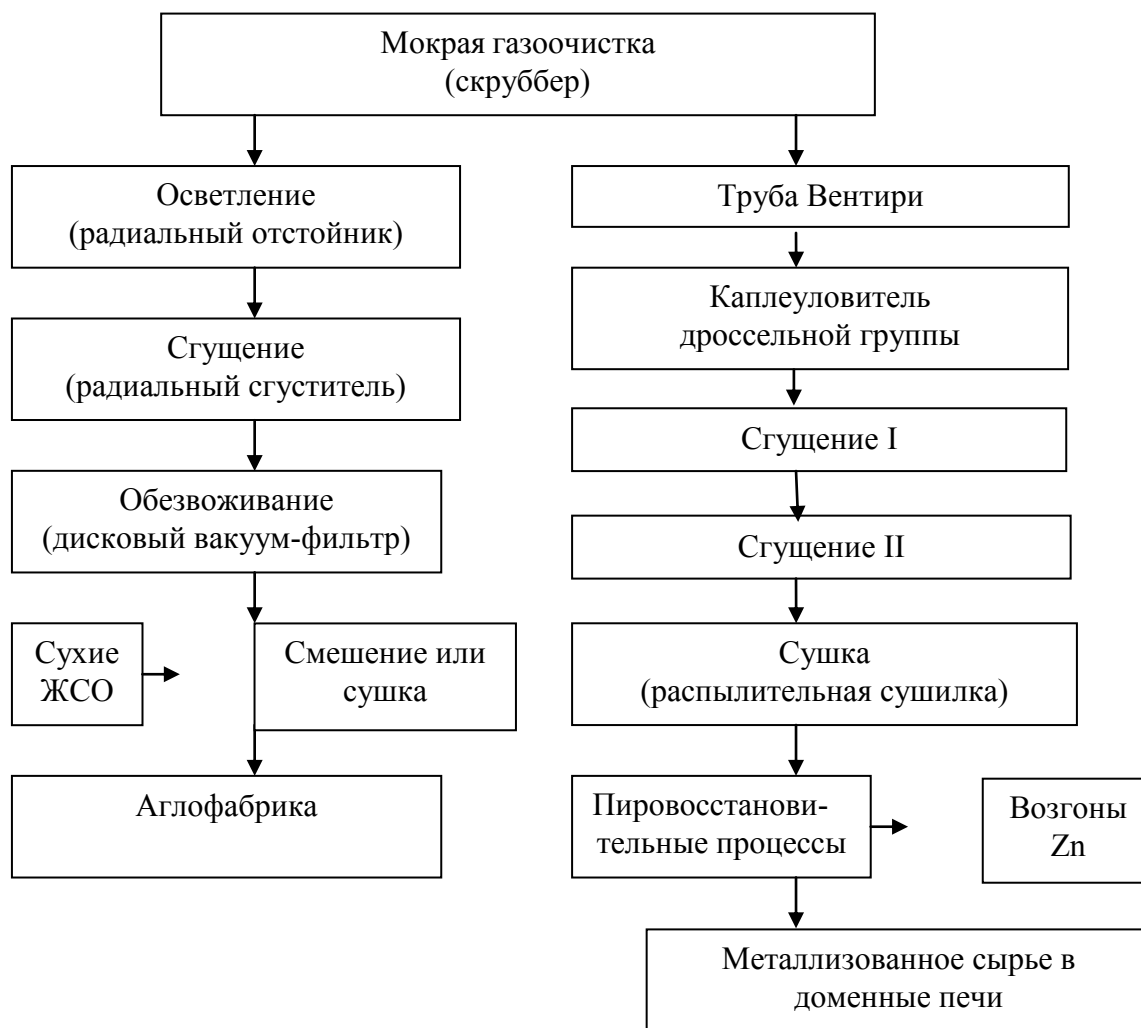
Рисунок - Технологическая схема подготовки цинксодержащих шламов тонкой газоочистки доменных печей с возгонкой цинка
