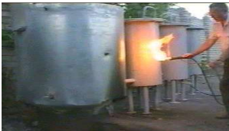
Рис 1. Установка УПП-1 для пиролизного получения газообразных, жидких и твердых энергоносителей из органического сырья (органических отходов) с непрерывным процессом тепловой мощностью 1 Мвт.
