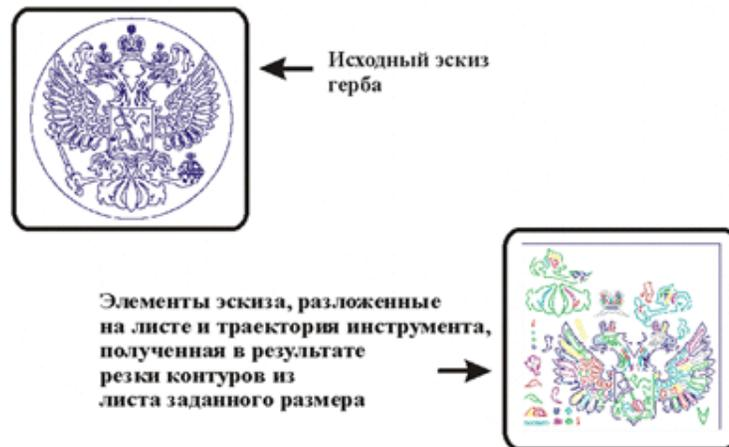
Рисунок 6.16 - Пример построение траектории движения инструмента
