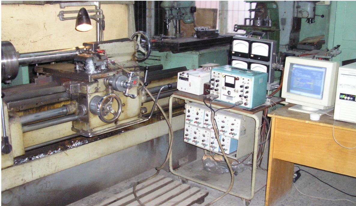
Рис. 2. Общий вид стенда для определения допустимых подач
