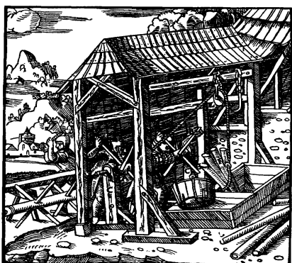
Рис.1 Подъем с помощью ручного ворота
