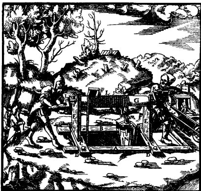
Рис.3 Подъем при помощи ручного ворота.
