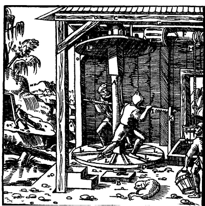
Рис.5 Подъемная машина с топчаком.
