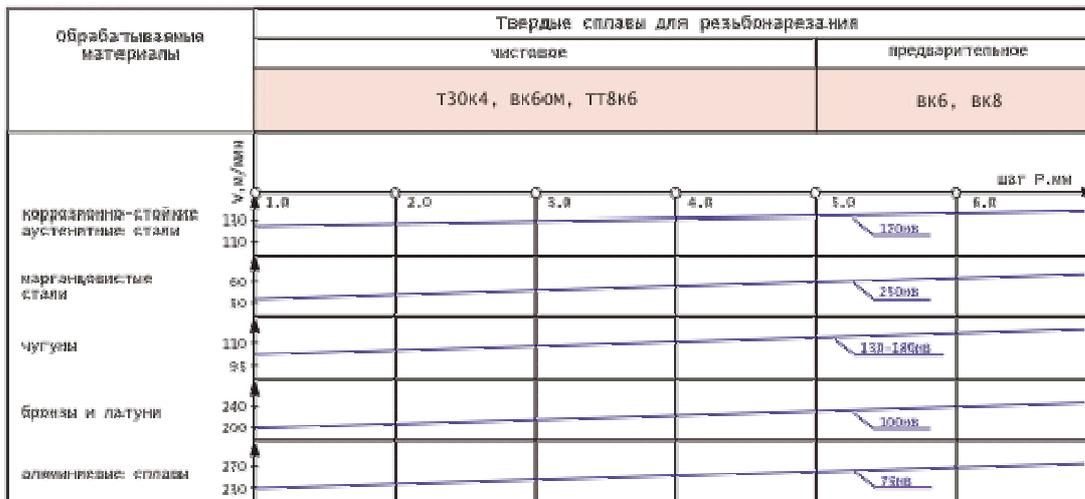
Рисунок 4.8 - Выбор марки твердого сплава для резьбонарезания сплавов группы М
