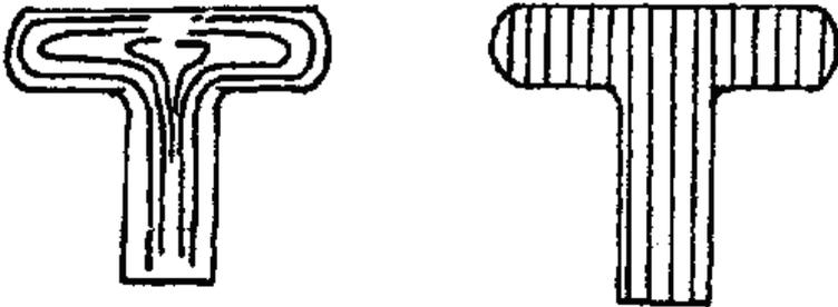
1. Какой болт изготовлен штамповкой, а какой обработкой резанием?
