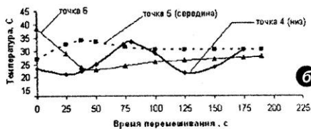
4. Динамика изменения температуры перемешиваемой жидкости при продувке в дискретном (a) и обычном (б) режимах
