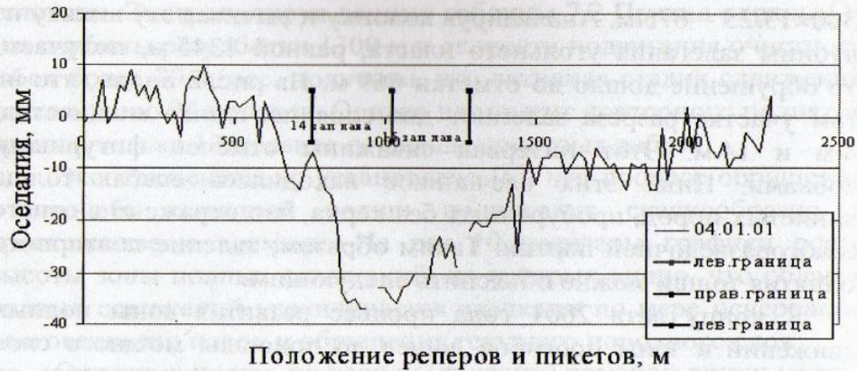
Рис. 11. График оседаний отрезка ж/д пути Донецк-Ясиноватая при подработке 15-й западной лавы (пласт m_3 на 04.01.2001 г.)
