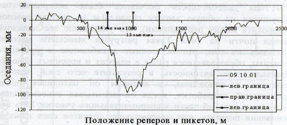
Рис. 12. График оседаний отрезка ж/д пути Донецк-Ясиноватая при подработке 15-й западной лавы (пласт m_3 на 09.10.2001 г.)
