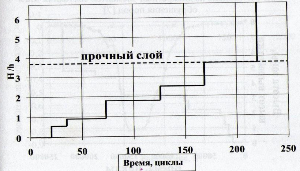
Рис. 13. Рост высоты обрушения над выработкой при отработке пятой физической модели на большом стенде [6]
