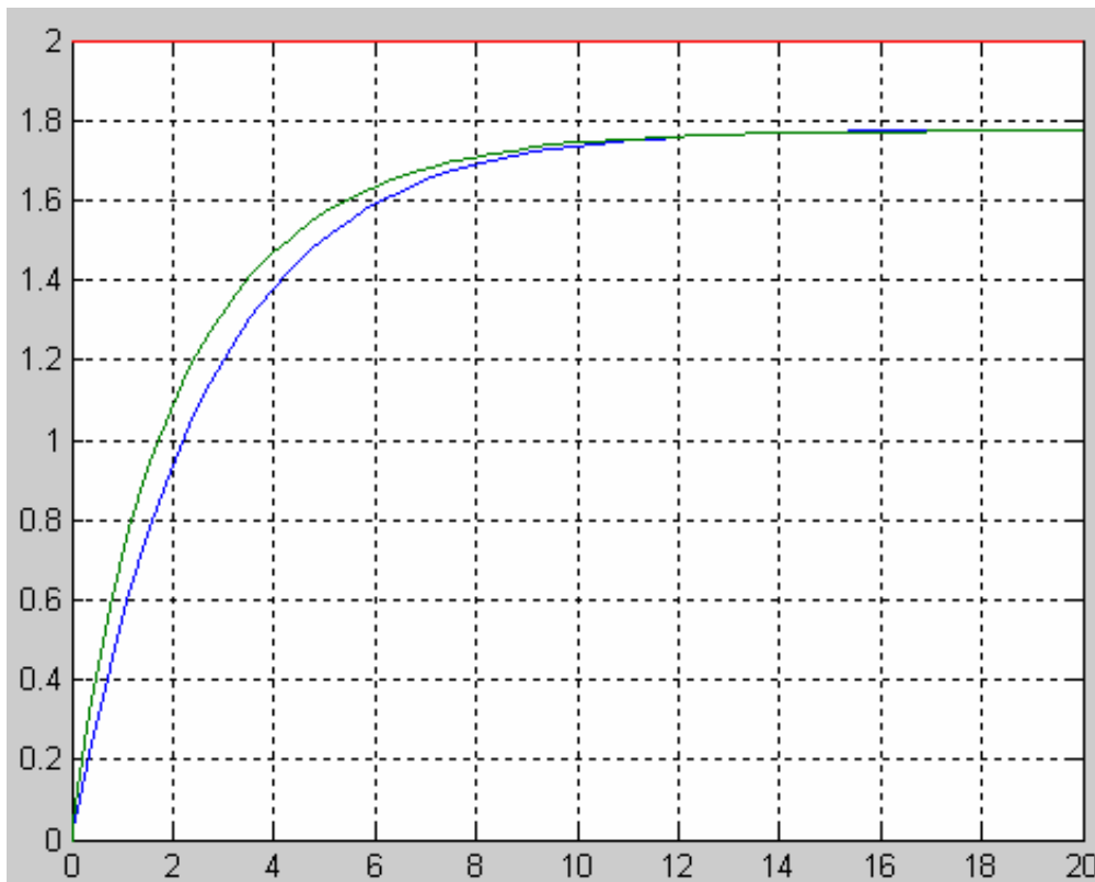
Рисунок 1.3. Процеси в нелінійній і лінеаризованій системах при вхідному впливі u = 2 .
