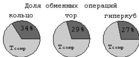
Рисунок 1 - Доля обменов к общему времени выполнения блочного метода с правилом Рунге для различных топологий
