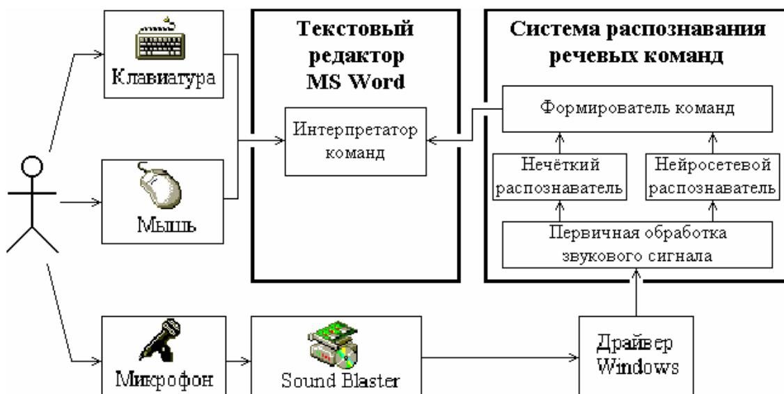
Рисунок 1 – Структура речевого канала управления текстовым редактором MS Word
