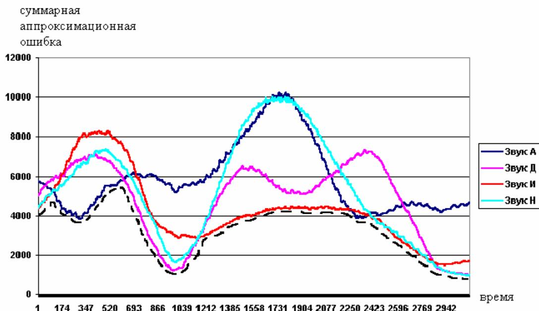
Рисунок 4 – Графики меры отличия входного сигнала от различных фонем для двух вариантов произнесения слова “один”: (---) – линия наименьших ошибок, определяющая наилучшую цепочку фонем
