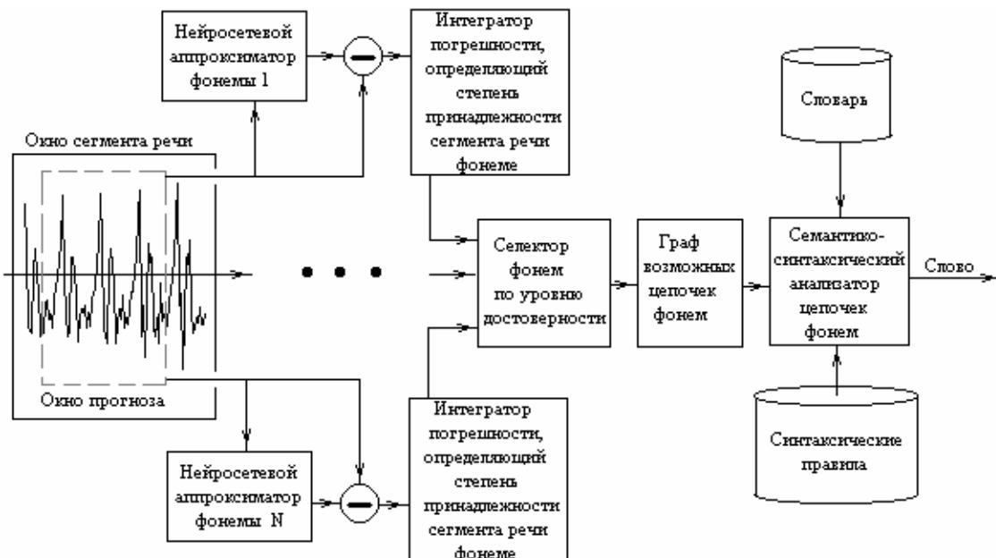
Рисунок 3 – Схема распознавания речи на основе нейросетевой аппроксимации фонем
