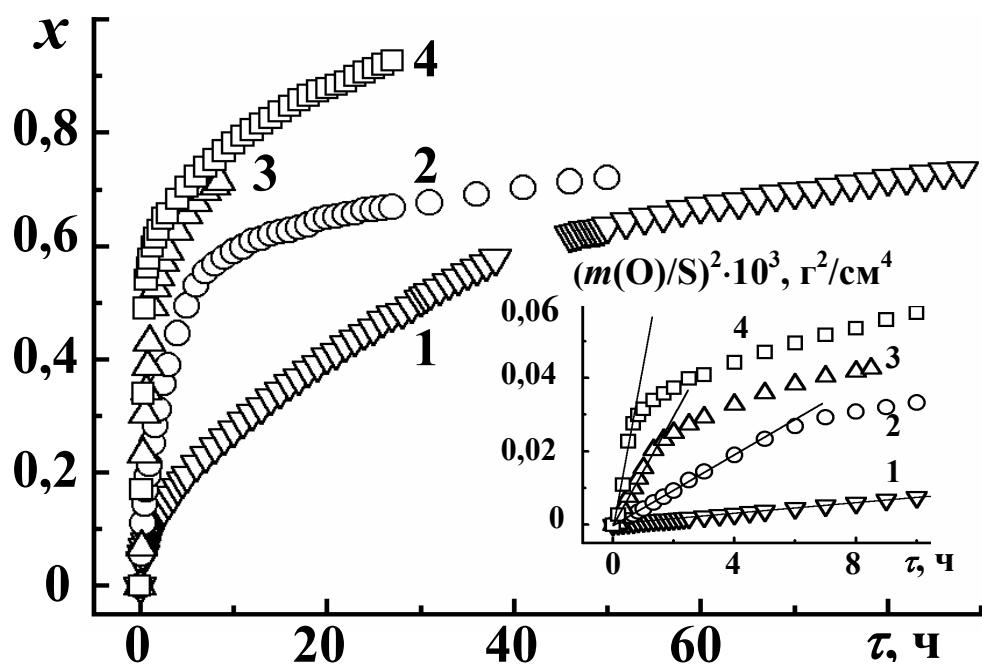
Рис.1. Кинетические кривые окисления медной фольги при температурах,  $^{\circ}\text{C}$ : 1 – 600; 2 – 700; 3 – 800; 4 – 900.
