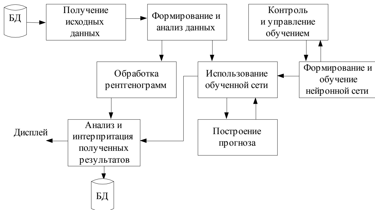
Рисунок 2 — Структурная схема компьютерной системы
