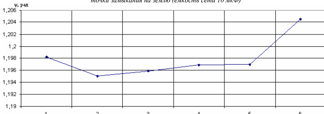
Рисунок 4 – Изменение фазы вектора тока нулевой последовательности по отношению к фазе вектора межфазного напряжения при перемещении точки замыкания на землю (емкость сети 10 мкФ)
