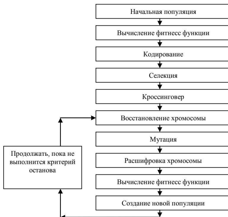
Рисунок 4 — Схема генетического алгоритма для задачи оптимизации компоновки оборудования
