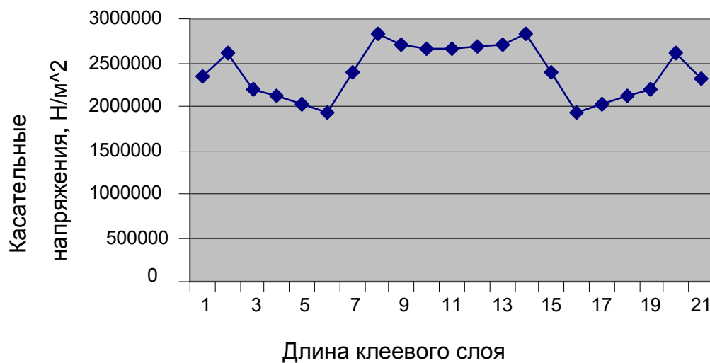
Рис. 7 - Распределение внутреннего напряжения в стыковом соединении
