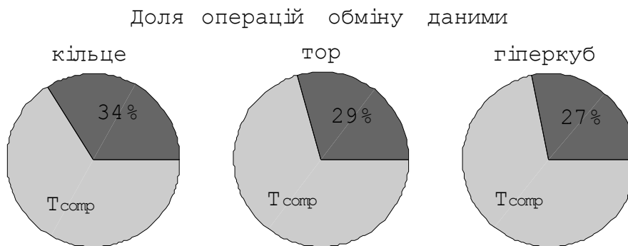
Рис. 3.4. Доля обмінів до спільного часу виконання блокового методу з правилом Рунге для різних топологій
