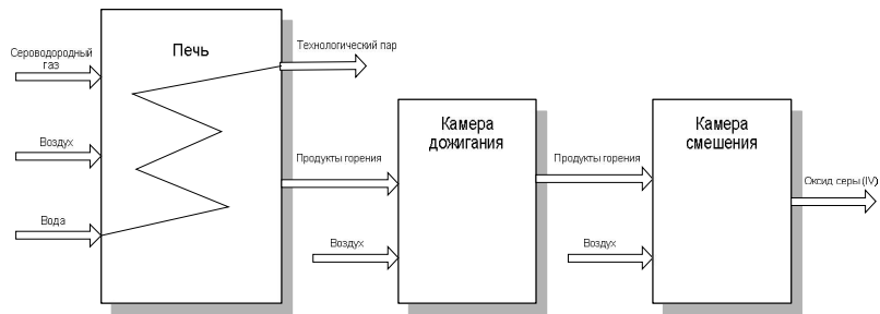
Рис. 1. Функциональная схема технологической цепочки получения оксида серы (IV) из сероводородного газа
