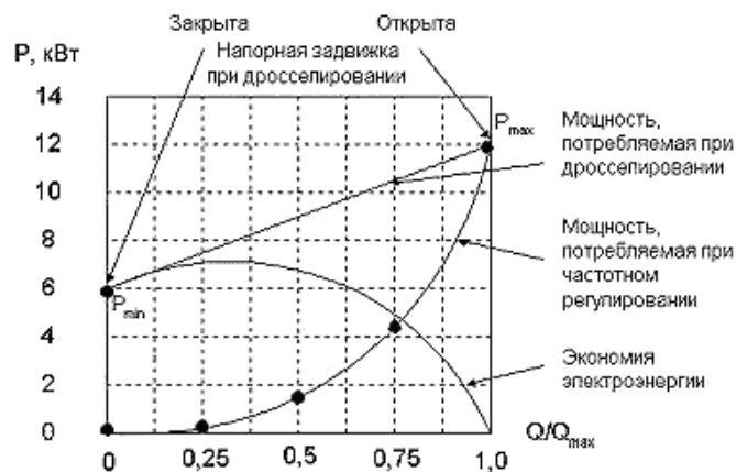
Рис.3 – Потребление мощности при различных способах регулирования скорости вращения насосов
