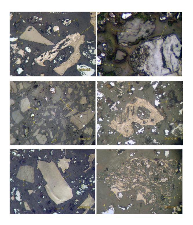
**Рисунок 1** - Микроструктура ПУТ и колошниковой пыли (размер кадра по горизонтали составляет 0,125мм)
