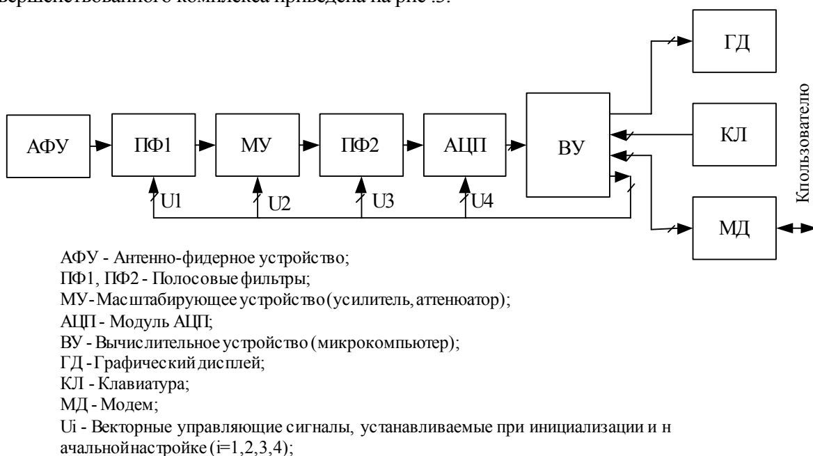
Рисунок 2 — Структурная схема компьютерной системы СДВ мониторинга
