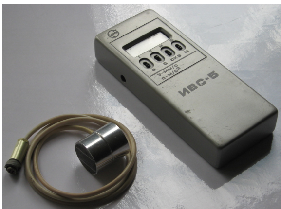
Виброметр ИВС-5 образца 1991 г.
