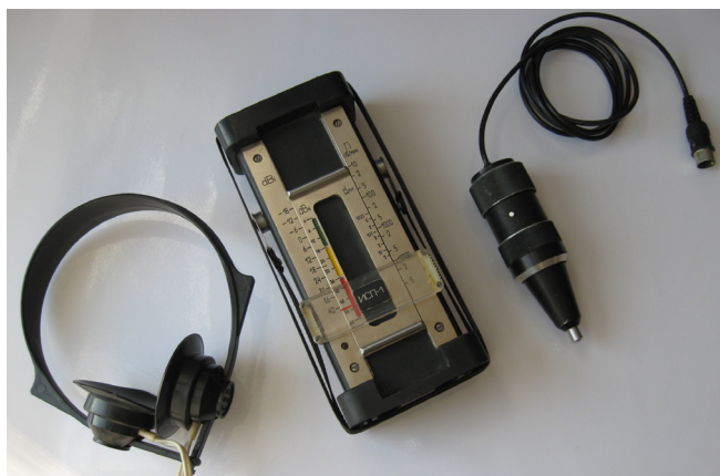
Индикатор ударных импульсов ИСП-1 образца 1991 г.
