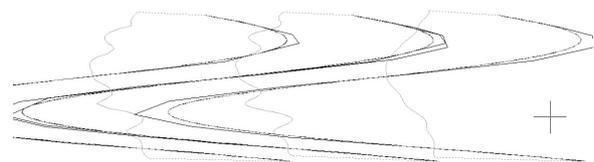
Рисунок 4 – Вид спереди. NURBzS шаблон примитива HELIX AutoCAD (слева) и аппроксимирующие  $b$ -сплайновые кривые – без улучшения (центре) и с улучшением с помощью  $v$ -кривой (справа)
