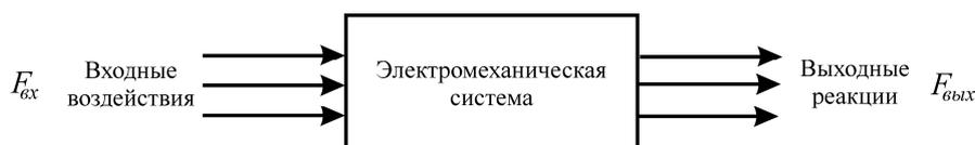
Рисунок 1 – Традиционное представление электромеханической системы в виде «черного ящика»
