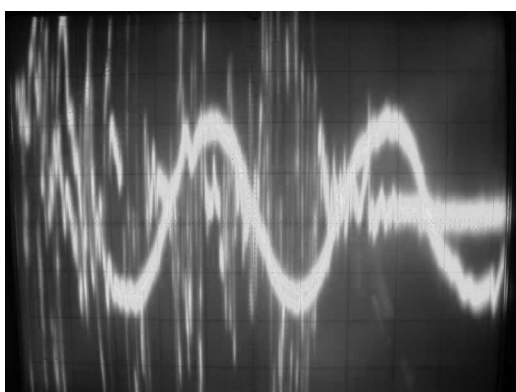
Рисунок 3 – Высокочастотные составляющие колебаний силы тока промышленной частоты, выделенные на резисторах 2 (0,001 В/дел, 5 мс/дел)
