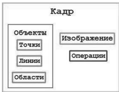
Рисунок 5 – Структура кадра изображения
