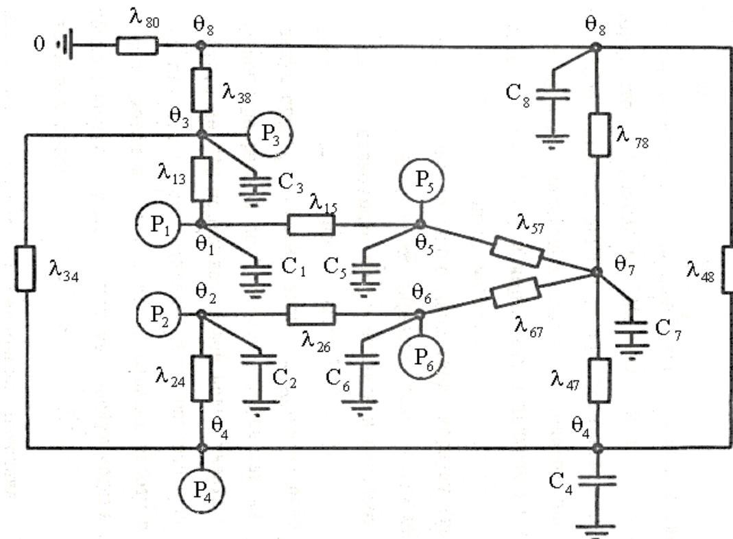
Рисунок 1 – Эквивалентная тепловая схема замещения асинхронного двигателя с фазным ротором типа МТН-312-6
