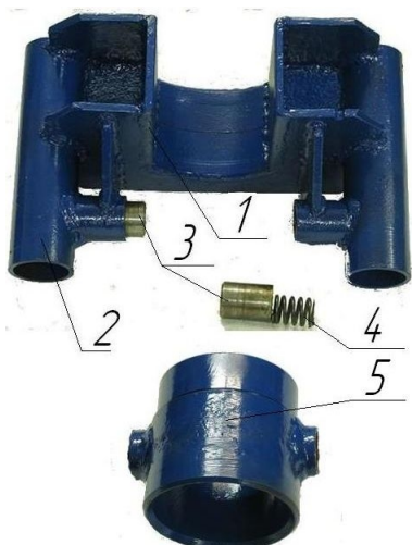
Рис. 3. Элементы подвижной направляющей каретки: 1 - корпус; 2 - направляющие патрубки; 3 - фиксаторы; 4 - пружина; 5 - поворотная воронка
