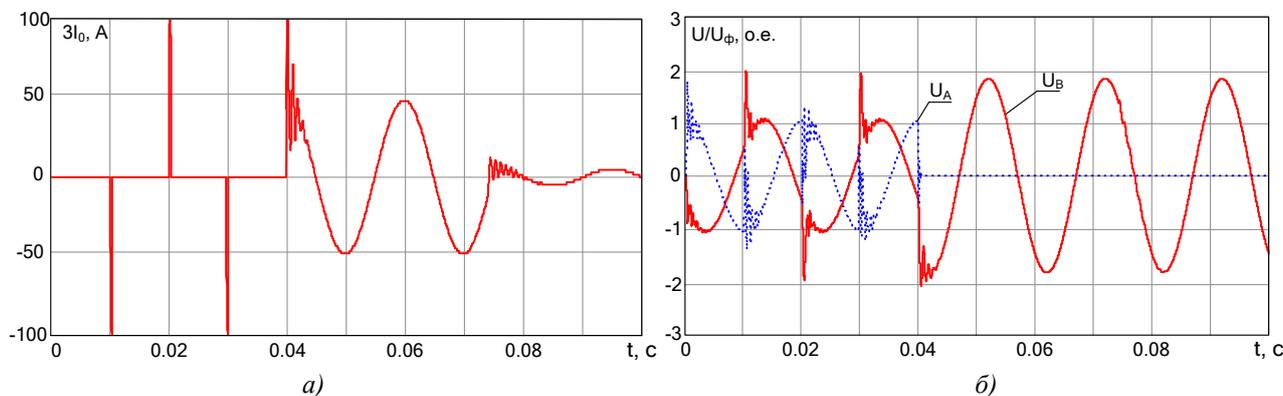
Рисунок 2 – Осциллограмма замыкания фазы *A* на землю в сети 6 кВ при резистивном заземлении нейтрали: а) изменение тока в месте *ОЗЗ*; б) изменение мгновенных напряжений в поврежденной ( $U_A$ ) и неповрежденной ( $U_B$ ) фазах
