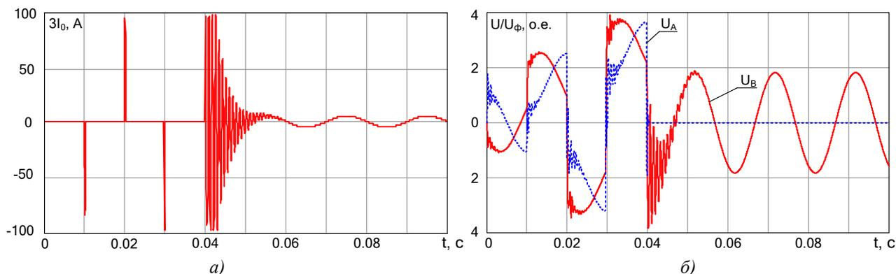
Рисунок 3 – Осциллограмма замыкания фазы *A* на землю в сети 6 кВ при изолированной нейтрали: а) изменение тока в месте *ОЗЗ*; б) изменение мгновенных напряжений в поврежденной ( $U_A$ ) и неповрежденной ( $U_B$ ) фазах
