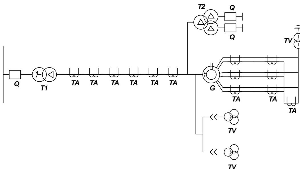
Рисунок 1 – Схема электрических соединений блока генератор-трансформатор
