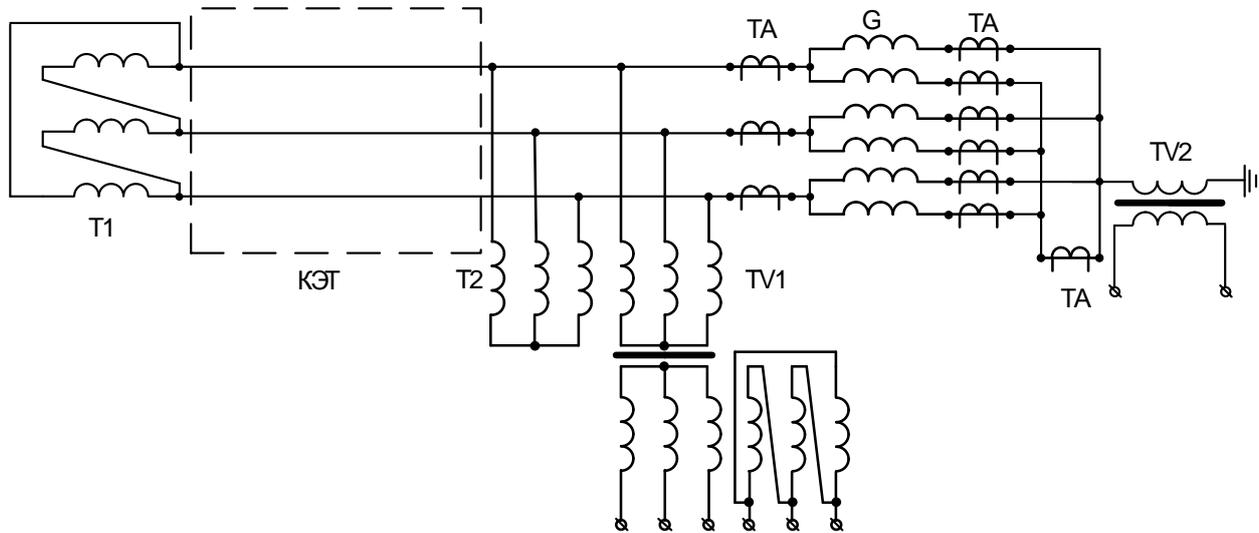
Рисунок 2 – Схема сети генераторного напряжения блока генератор-трансформатор
