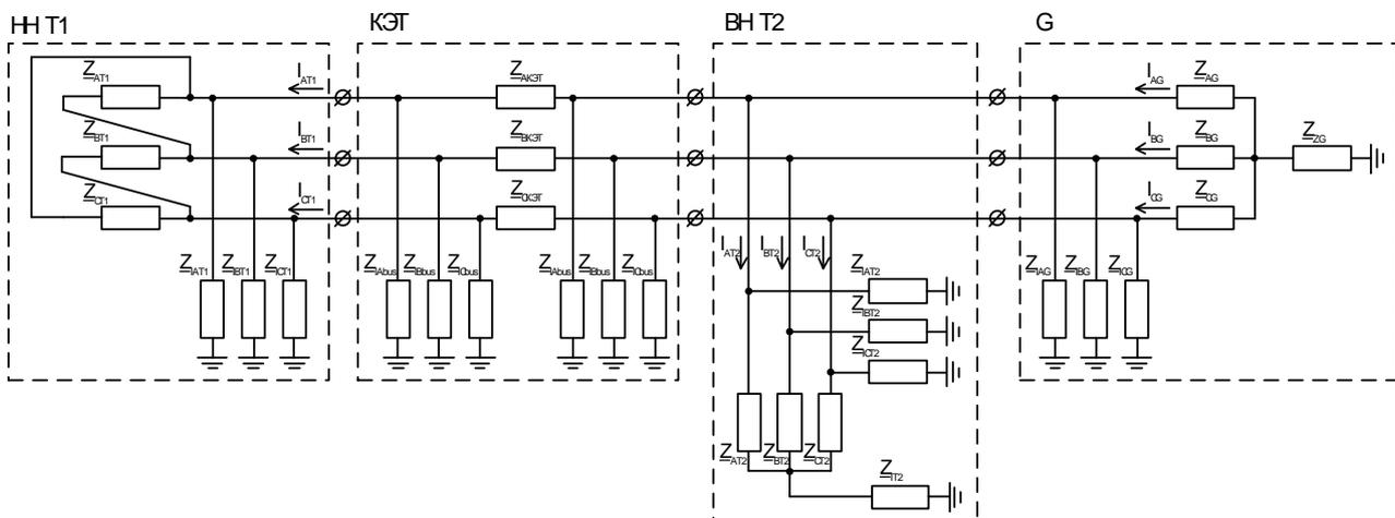
Рисунок 3 – Схема замещения системы генераторного напряжения
