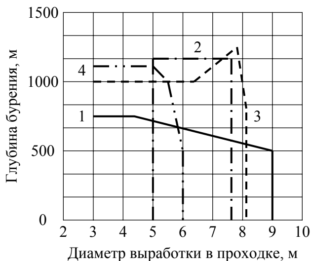
Рис.1. Диаметры и глубины бурения, достигнутые различными способами бурения:
