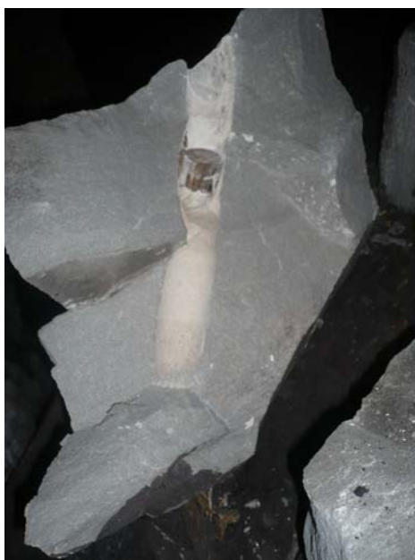
Рис. 5 – Общий вид стенок шпура с НРС после разрушения блока
