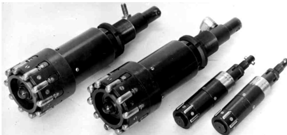
Рис. 3. Сепараторные раскатники жесткого типа
