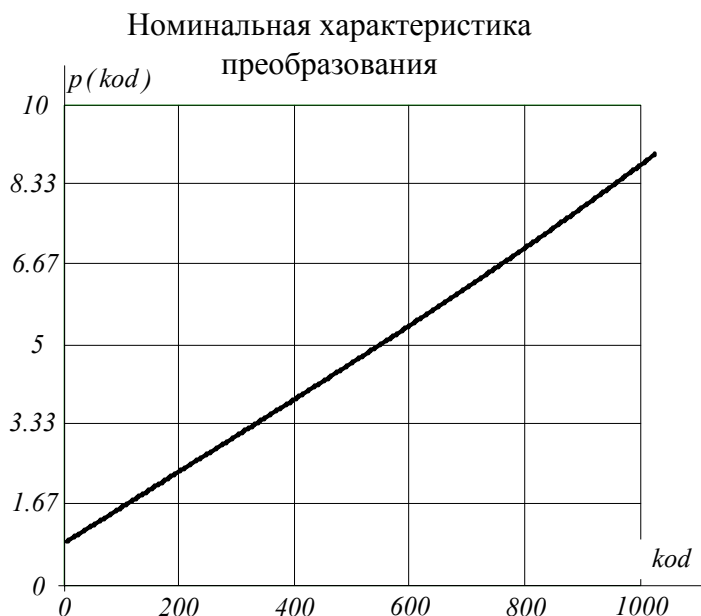
Рисунок 6 – Апроксимуючий поліном (а) і графік номінальної характеристики перетворення вимірювальної системи (б)
