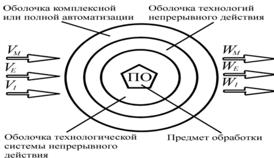
Рис. 2. Гипотетическая модель иерархических уровней (оболочек) охвата процесса технологических преобразований ПО при комплексной или полной автоматизации производственных процессов
