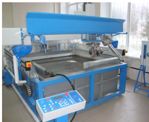
Рис. 3. Общий вид гидроабразивной установки с бункером для подачи абразива
