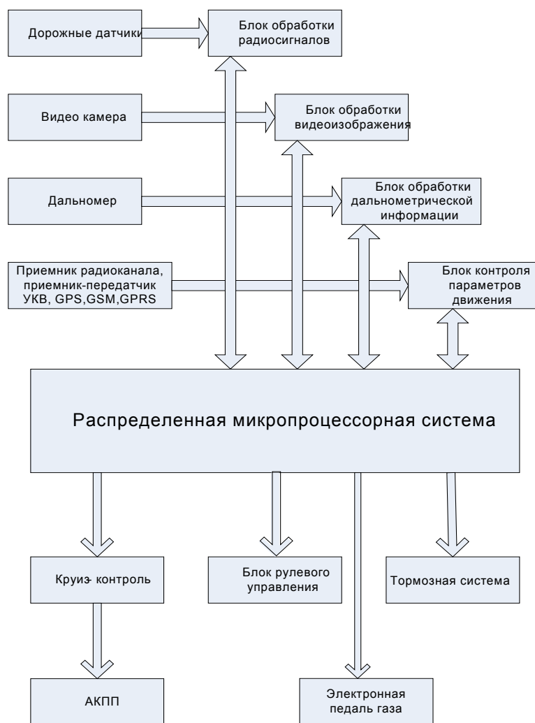
Рисунок 1 – Структура распределенной системы управления транспортным средством
